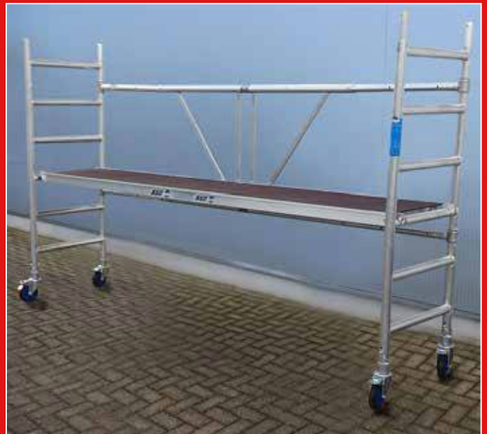
Teleskooppisen asennustelineen pituutta voidaan säätää jolloin samassa asennustelinerungossa voidaan tilanteesta riippuen käyttää 1,90 m, 2,5 m ja 3,05 m pitkiä työtasoja.
